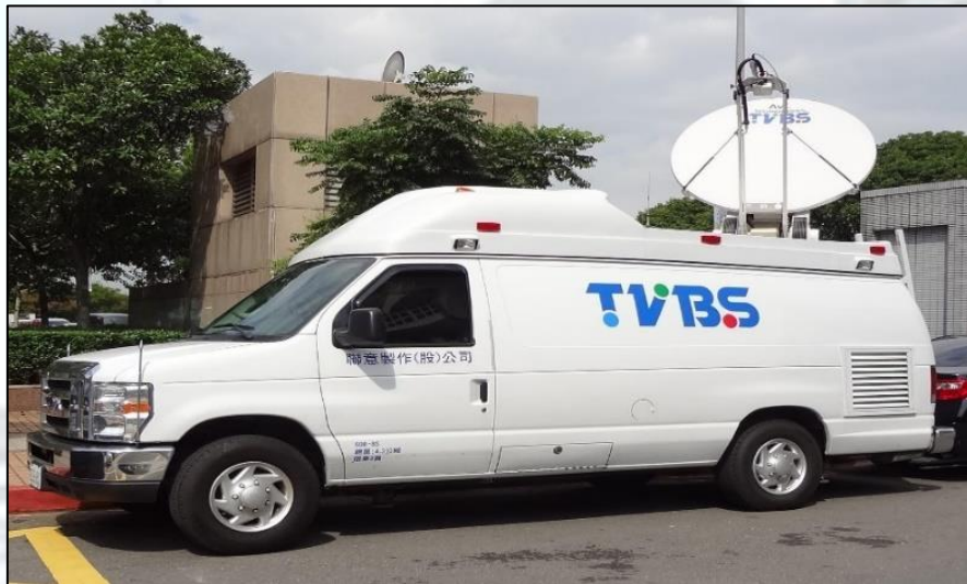
圖1 衛星SNG車示意圖
