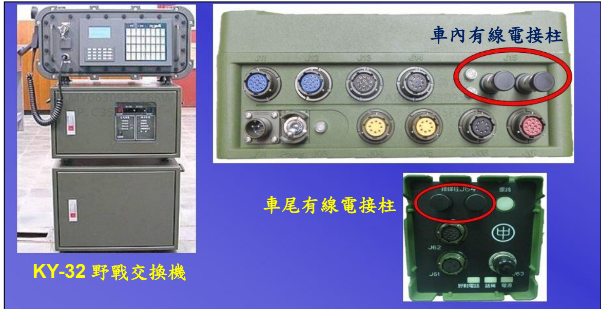
圖23-有線電整合車內(尾)有線電接柱位置
