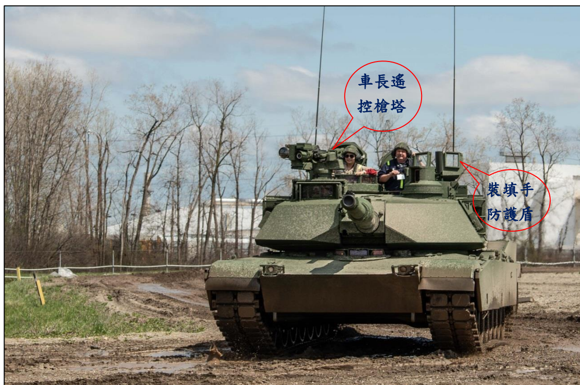
圖21-新式戰車塔頂武器防護措施
