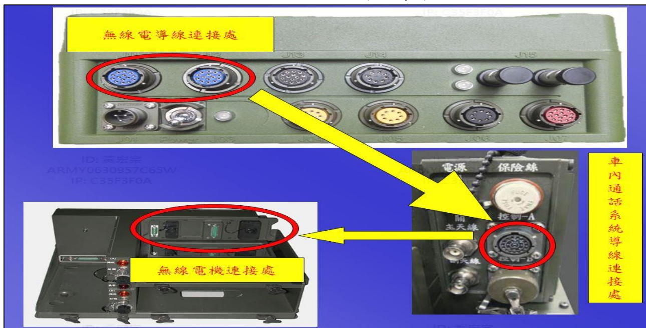
圖25-HITS-3000無線電導線連接圖
