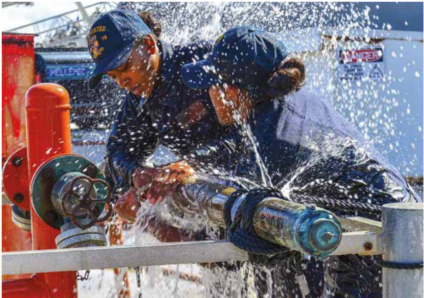
2017年10月24日，在希臘蘇達灣海軍支援活動(Naval Support Activity Souda Bay)期間，波特號驅逐艦(USS Porter)的水手在損害管制競賽中使用管路補片(Jubilee Pipe Patch)。(Source: USN/ Krystina Coffey)
