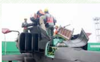
安裝主旋翼葉片
