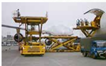
機身自機艙移出，利用液壓板車使機身下降
