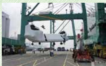
將飛機緩慢脫離船甲板
