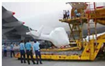
機身自機艙移出，利用液壓板車使機身下降
