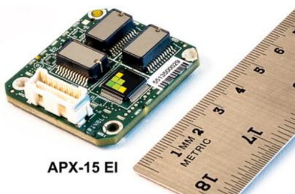
圖 9 APX-15 EI UAV 外部 IMU
