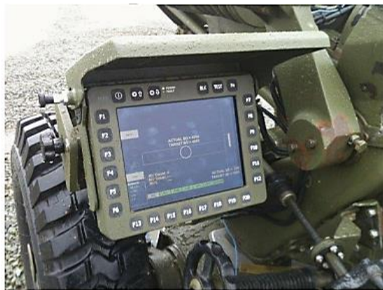
圖 4 安裝於英軍 L118 式 105 公厘輕榴彈炮左砲耳之新型瞄準手顯示與控制單元 (LDCU)
