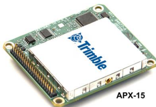
圖 8 APX-15 UAV 單板 GNSS 裝置
