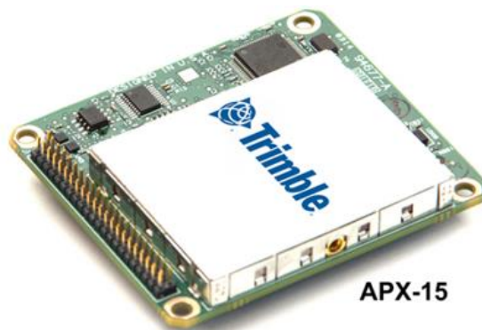
圖 8 APX-15 UAV 單板 GNSS 裝置
