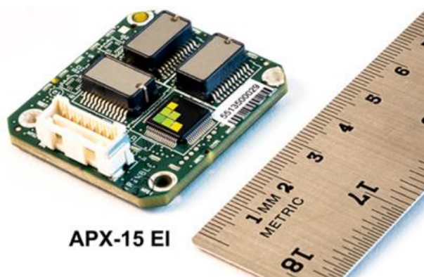
圖 9 APX-15 EI UAV 外部 IMU
