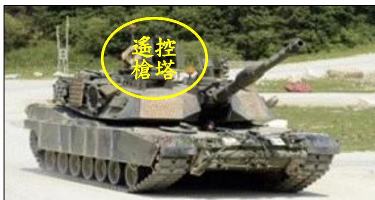
圖 24-M1A2 車裝遙控武器工作站
