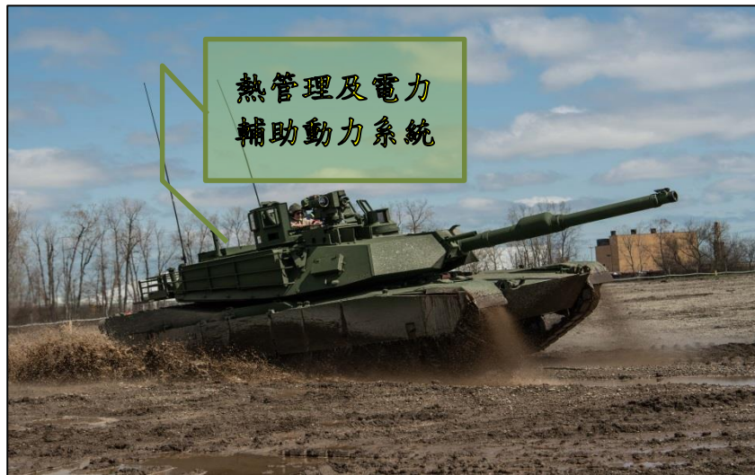
圖 36-M1AT2 熱管理及電力輔助動力系統位置
