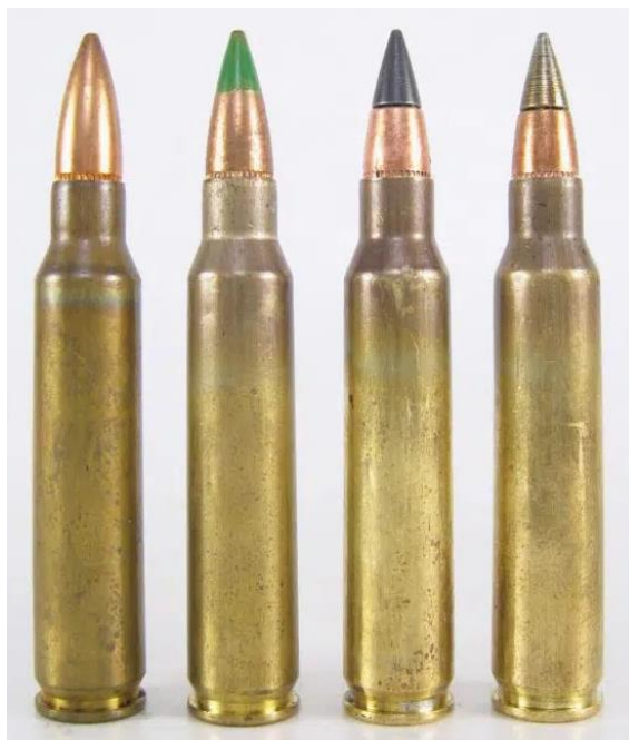
圖1. 左一為M193、左二為M855、右二為M855A1彈藥（鋼心外露、錫鉛合金核心）、右一為M855A1（鋼心外露、銅合金核心）彈藥[10]
