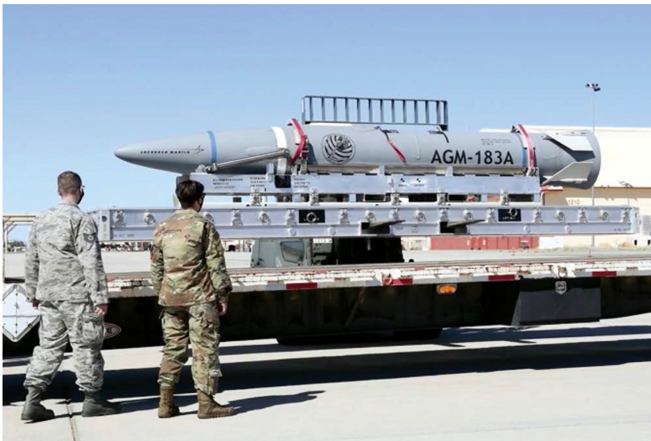
AGM-183A空射快速反應武器是一種極音速飛彈，用於遠距攻擊高價值目標，照片中顯示該飛彈於加州愛德華空軍基地(Edwards Air Force Base)準備掛載於B-52轟炸機進行飛行測試。(Source: USAF/Giancarlo Casem)
