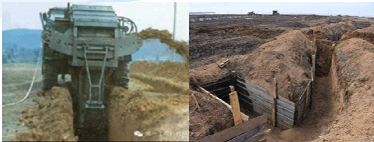
圖14 烏克蘭運用PZM-3機械投入工事構築
