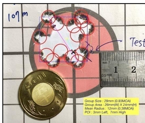
圖十 國造 T93K1 狙擊槍 107 公尺處 15 發 1 群極致精度表現
