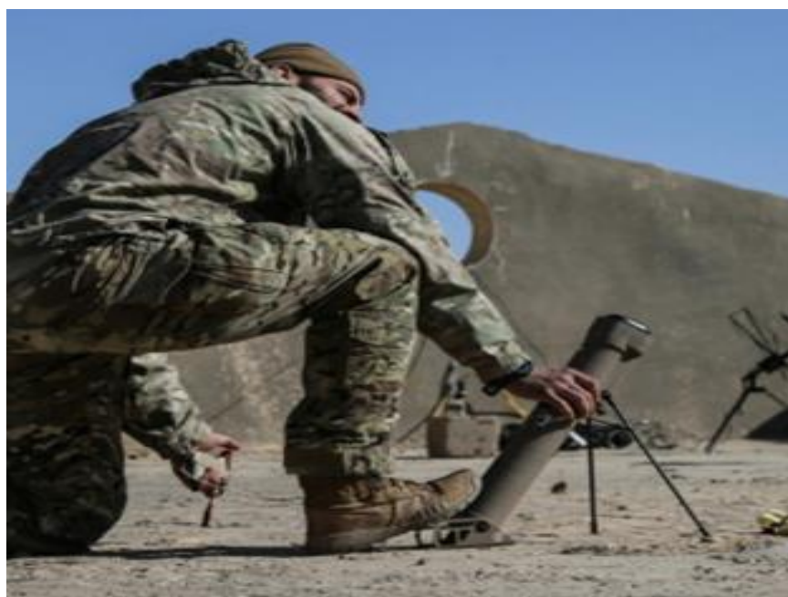
圖七 Switchblade 300，採用筒式發射方式
