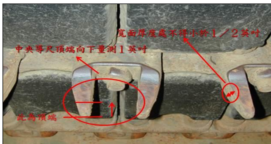
圖 72 中央導齒量測方式
