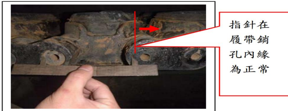
圖 64 履帶襯套正常
