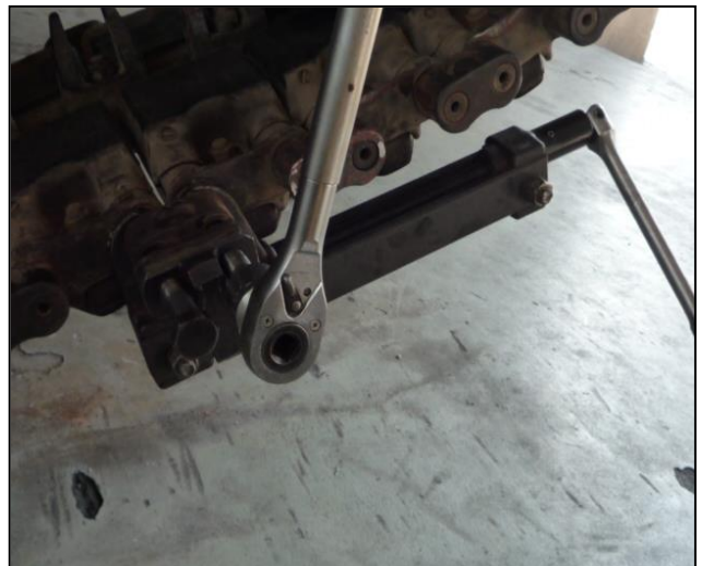
圖 31 -交互鎖緊終端連接器拔取器螺釘
