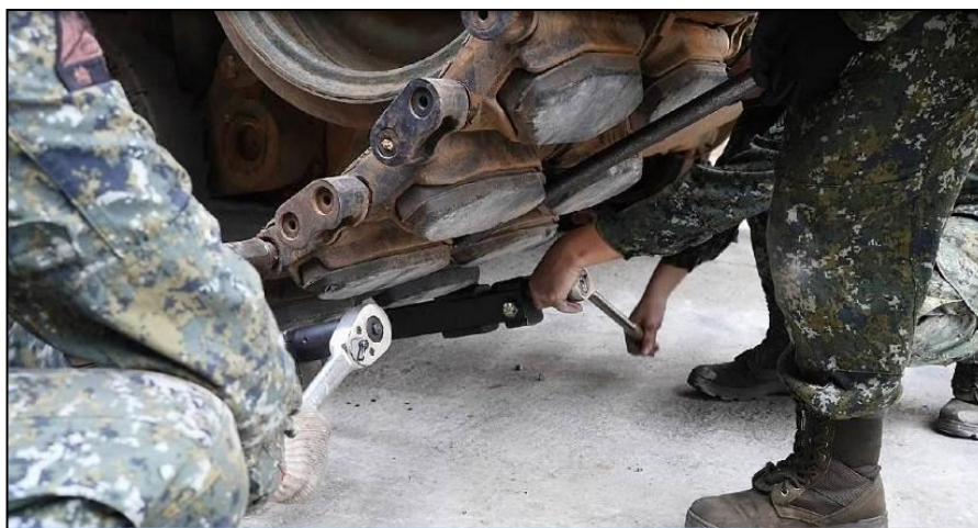
圖 34-平均鎖緊履帶夾方式
