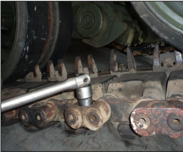
圖 28-拆卸楔型鐵與固定螺絲
