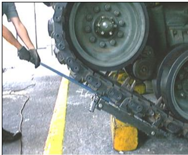
圖 33-撬棒支撐履帶方式
