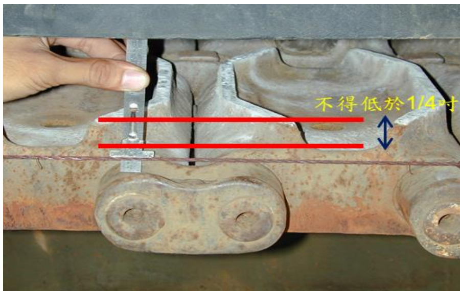
圖 73 履帶金屬爬齒檢查標準
