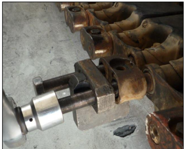
圖 29-拔取器使用方式
