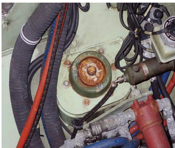
圖1：液壓控制單元與懸吊支架腐蝕、外層油漆脫落，導致內層金屬裸露。(Source: Eric Brown)
