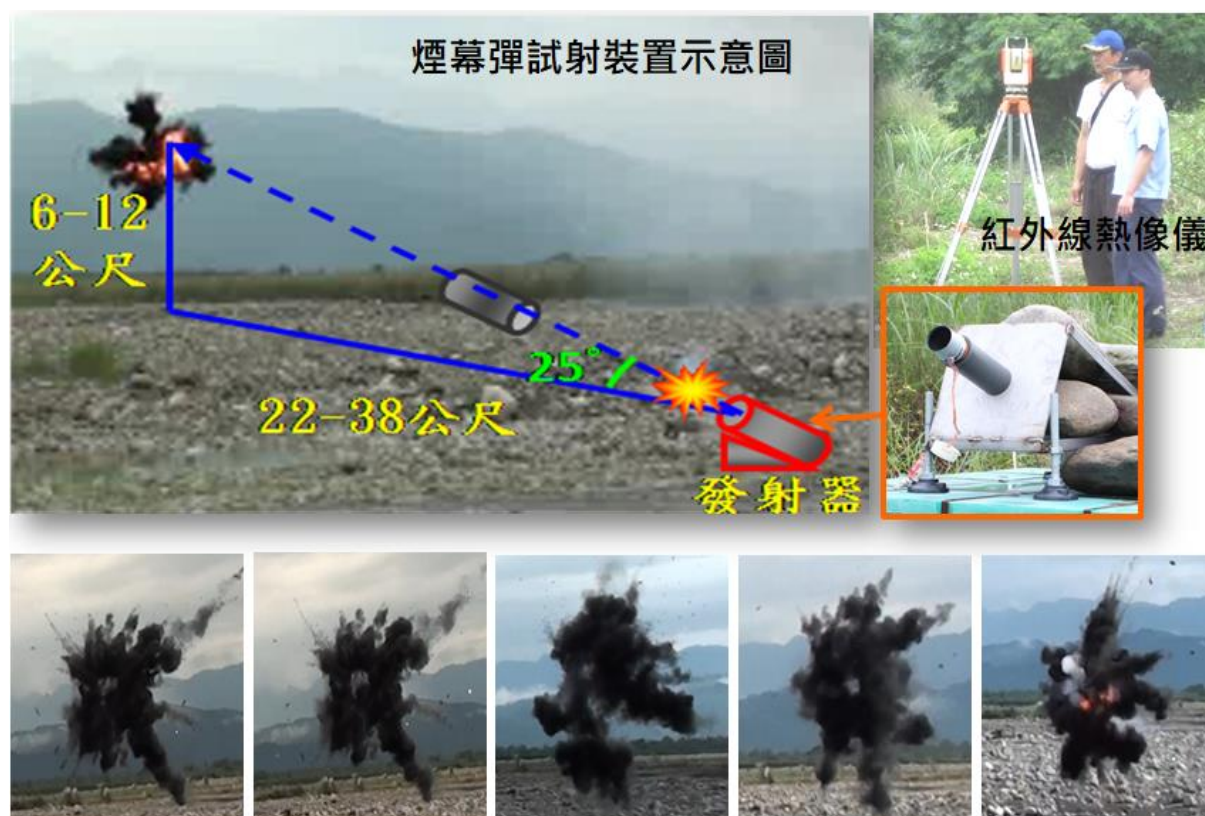
圖 6 磁性膨脹石墨煙幕彈發射爆破觀測圖及紅外線熱像儀測量
