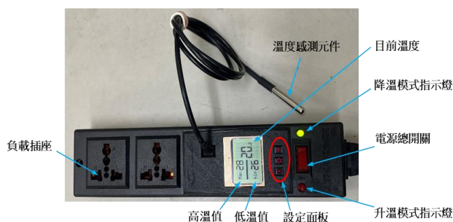
圖 5. 可擴充主從式 IOT 溫控延長線完成圖
