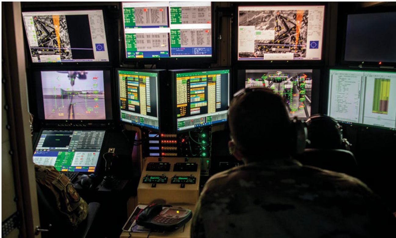
相較於載人飛機，遙控飛機受到更多的人員監督。於內華達州克利契空軍基地的空軍士兵在MQ-9死神無人機開始自動起飛前，執行飛行前安檢作業。(Source: USAF/Omari Bernard)
