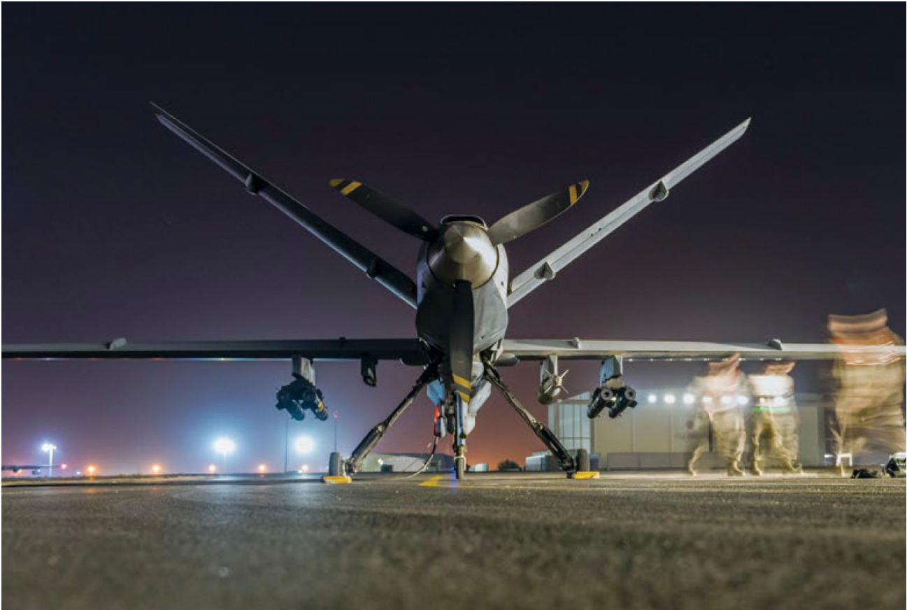
遙控飛機的速度比戰鬥機慢，並能就可能之地面目標，提供指揮官更穩定的影像。由西南亞基地起飛之MQ-9死神無人機提供了必要的持續性，確保在飛行高度較高或移動速度較快的飛機無法察覺目標的干擾因素下，仍能積極對目標進行識別。(Source: USAF/Jeremy Mosier)
