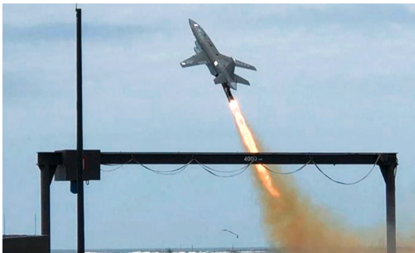
一架安裝「空中博格」自主核心系統之克拉托斯(Kratos)公司製UTAP-22戰術無人機，自美國佛羅里達州廷德爾(Tyndall)空軍基地發射升空。「空中博格」專案目標係將全任務自主能力，與可承受戰損、成本低廉的無人空中載具整合，俾實現載人與無人機編隊能力。(Source: USAF)
