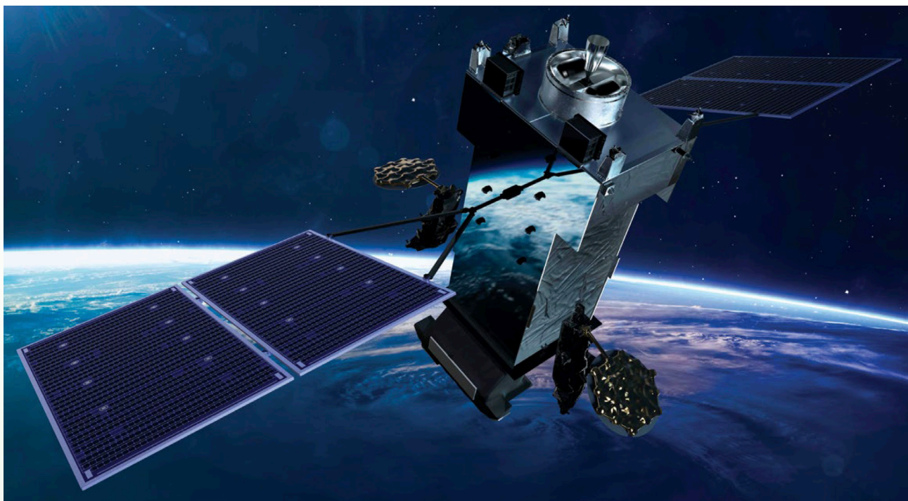
此為地球同步軌道上的次世代高空全時紅外線飛彈預警(Next-Gen OPIR)系統示意圖。此系統規劃取代現役太空基紅外線系統，預於2025年首度啟用。(Source: Lockheed Martin)
