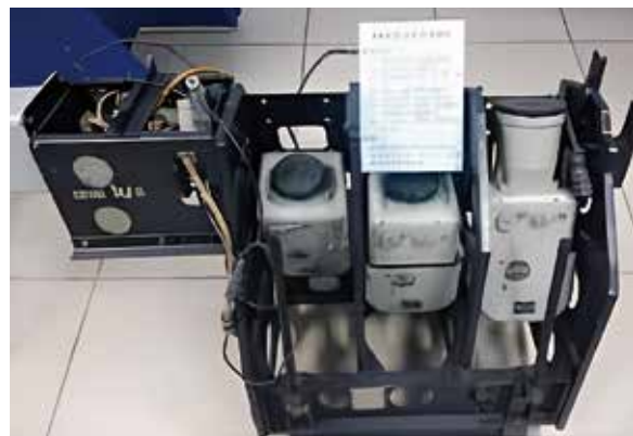
其中一架編號〇七五二的RCH-1偵察機，配有兩具KS-67前傾式相機（上圖） 【照片取自第五聯隊隊史館】。
