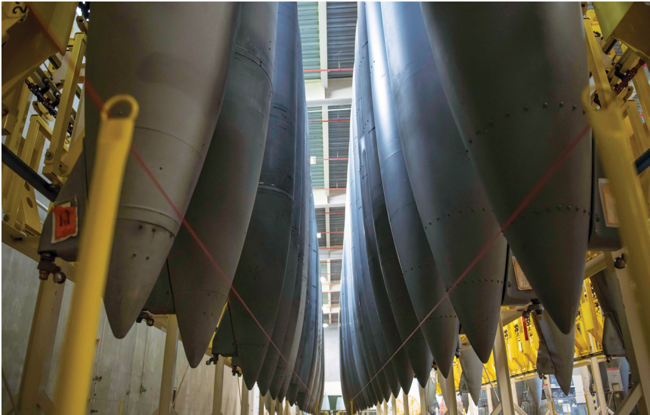
駐日美軍嘉手納空軍基地(Kadena Air Base)第18保修中隊燃料大樓中，戰機外掛油箱排列存放於垂直油箱儲存系統。此高密度油料存放系統單一油箱儲存所需空間較水平存放減少約88%。(Source: Senior Airman Jessi Roth)
