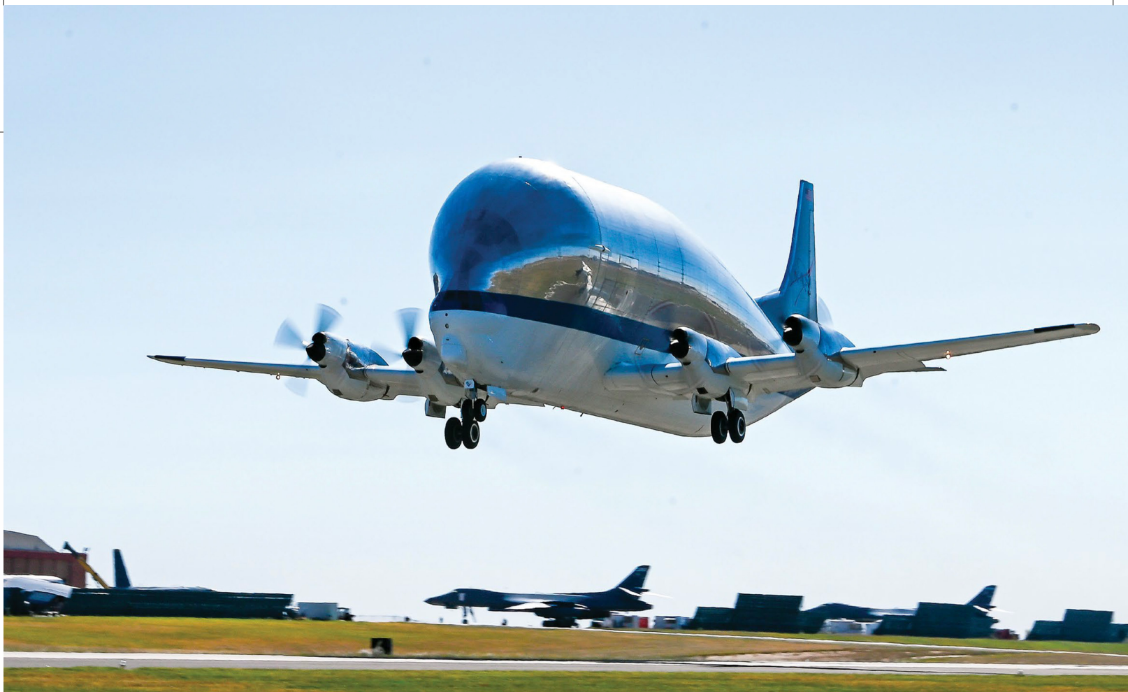
2022年10月18日，航空航太公司(Aero Spacelines)的超級彩虹魚(Super Guppy)運輸機於前往佛羅里達州途中，相當罕見地停留奧克拉荷馬州廷克空軍基地(Tinker Air Force Base)補充油料。該架美國國家航空暨太空總署(NASA)飛機為某項將於數年後執行的任務，運送獵戶座(Orion)太空船隔熱罩。超級彩虹魚的巨大貨艙具備3萬9,000立方英尺的可用空間，較C-5銀河(Galaxy)運輸機貨艙大26%。(Source: USAF/Mark Hybers)
