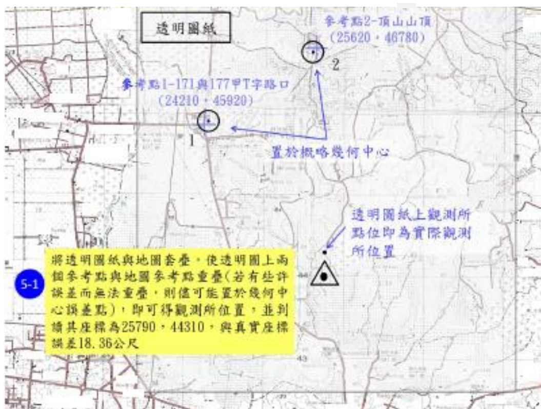
圖 15 二點交會法人工作業步驟示意圖（五）
