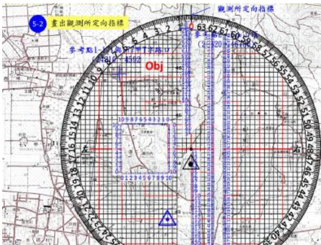
圖 16 二點交會法人工作業步驟示意圖（六）
