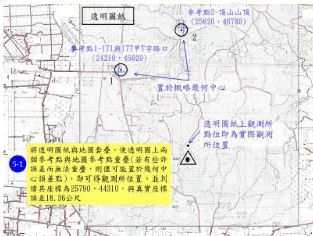
圖 15 二點交會法人工作業步驟示意圖（五）
