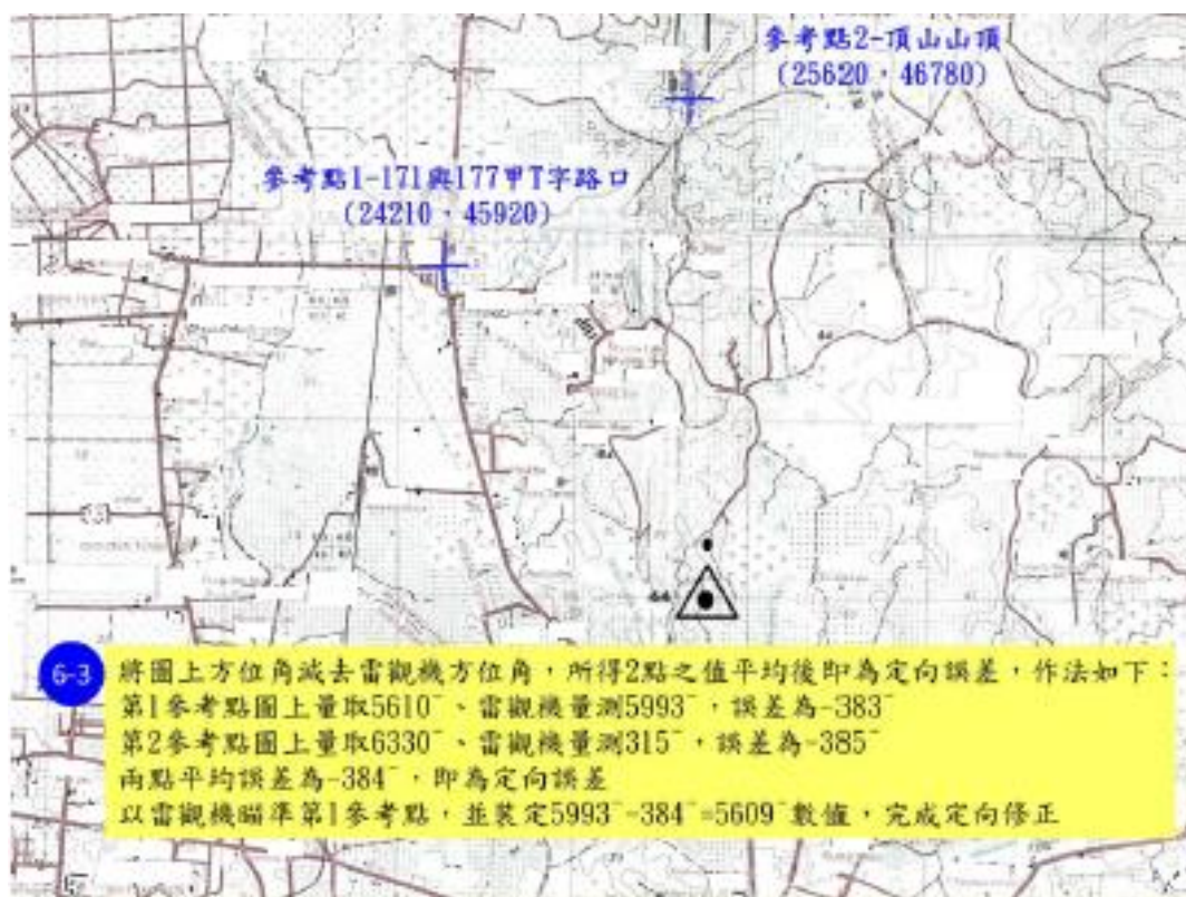
圖 18 二點交會法人工作業步驟示意圖（八）
