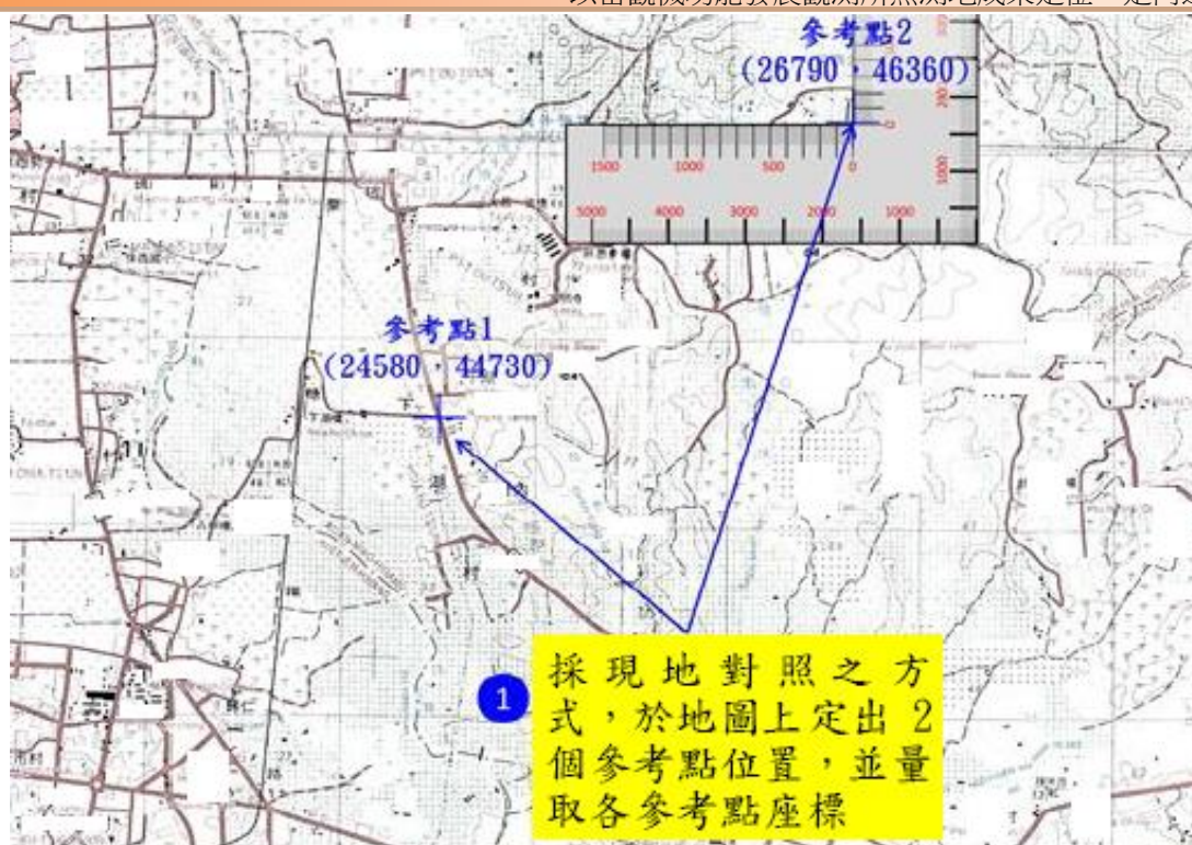
圖 5 以 Special tasks—AZ V D 功能修正觀測所定位及定向作業示意圖（一）
