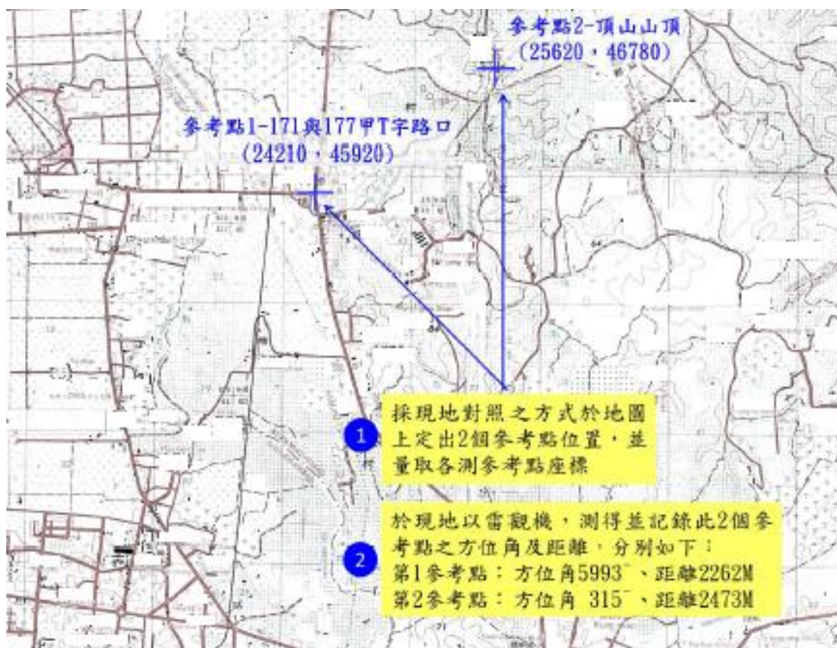
圖 11 二點交會法人工作業步驟示意圖（一）
