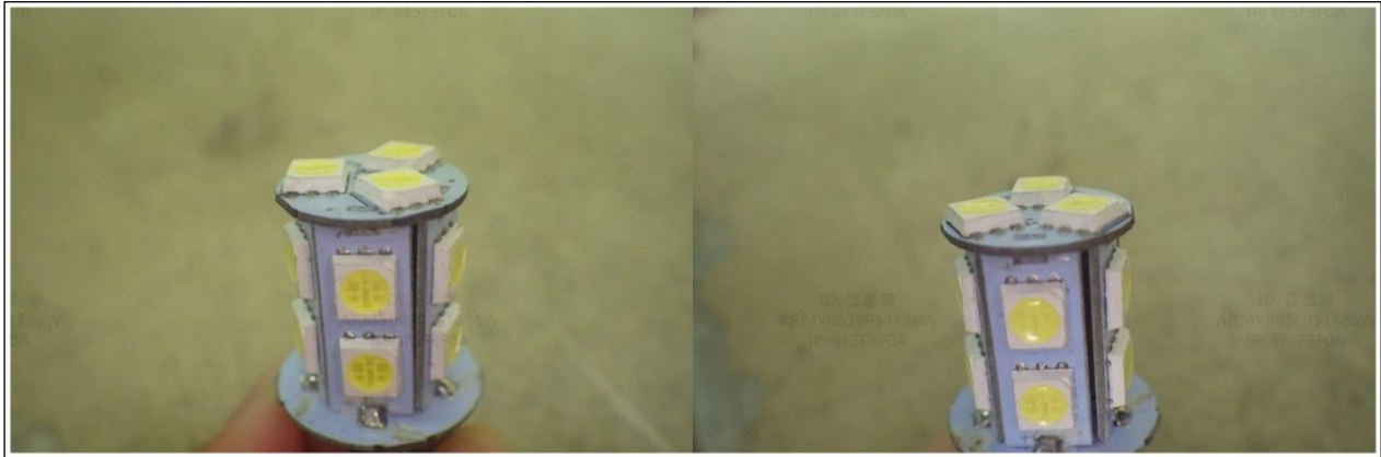
圖 49-主體架構上總共設置 10 個 LED 燈珠
