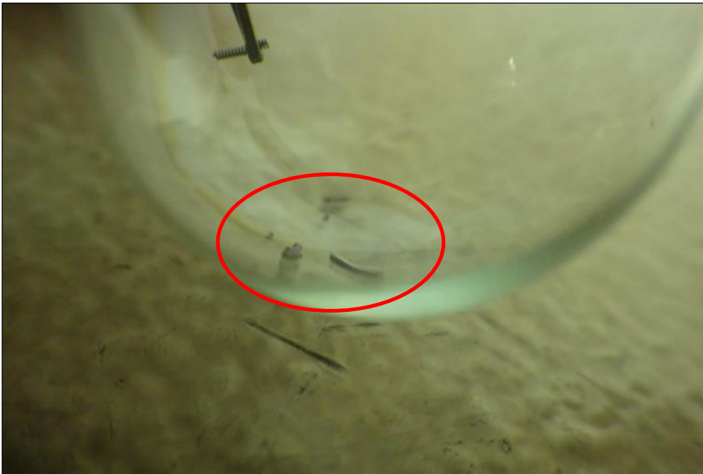
圖 25-鎢絲產生斷裂現象
