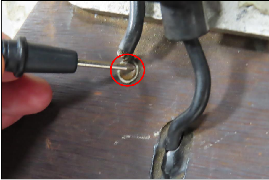
圖 44-黑色探針前端觸碰負極線簇與板身連接之接點
