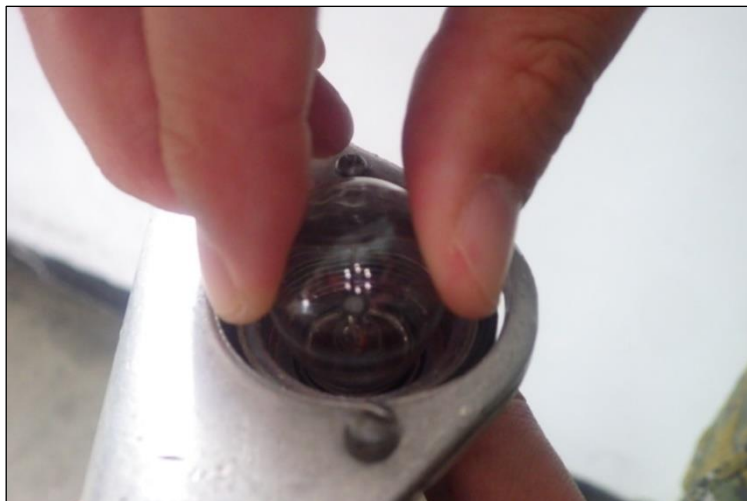
圖 29-輕輕抓住燈泡玻璃外壁
