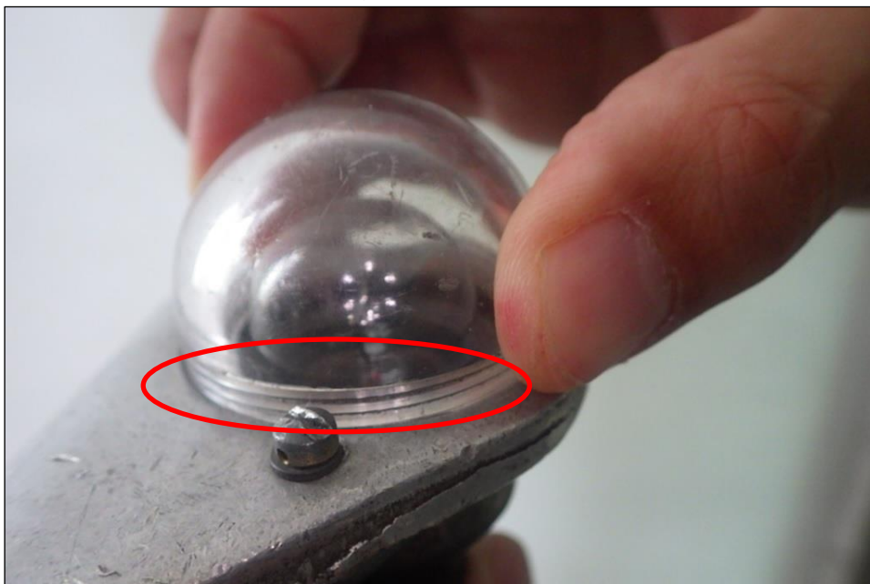
圖 35-燈泡透明保護罩平穩放置 L 支撐架並對正螺牙
