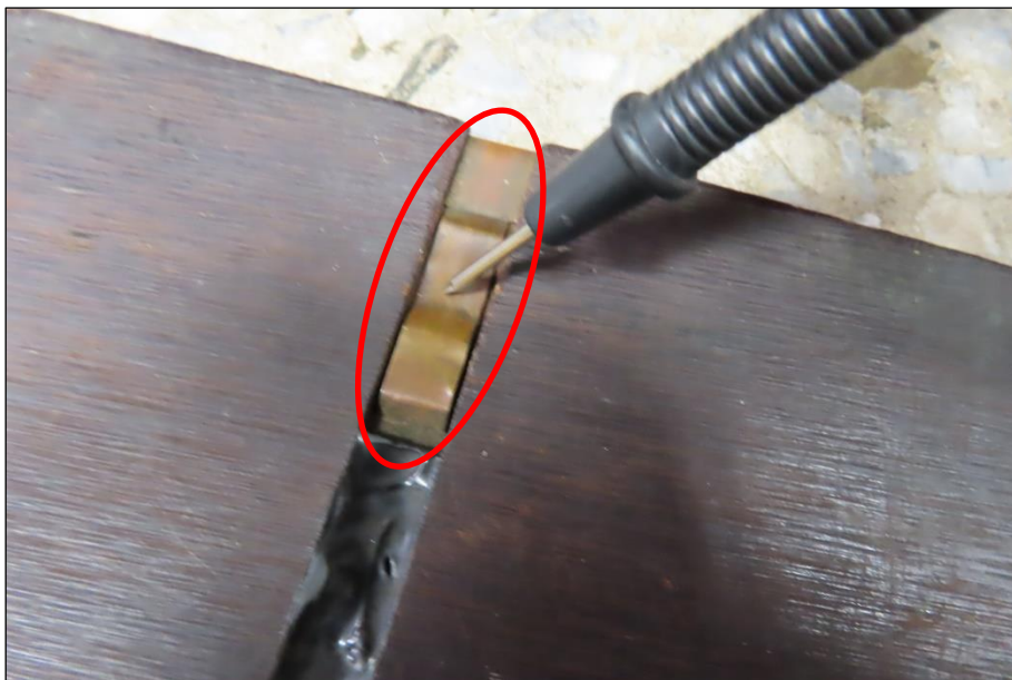
圖 41-黑色探針前端觸碰正極接觸銅面之表面
