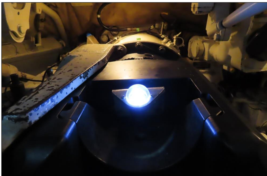
圖 51-實施擊發電路測試 LED 燈泡亮起
