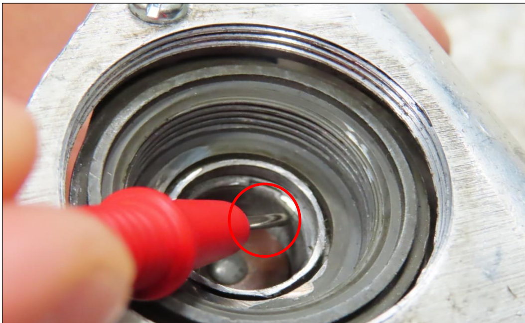
圖 43-紅色探針前端觸碰燈泡座側邊負極面
