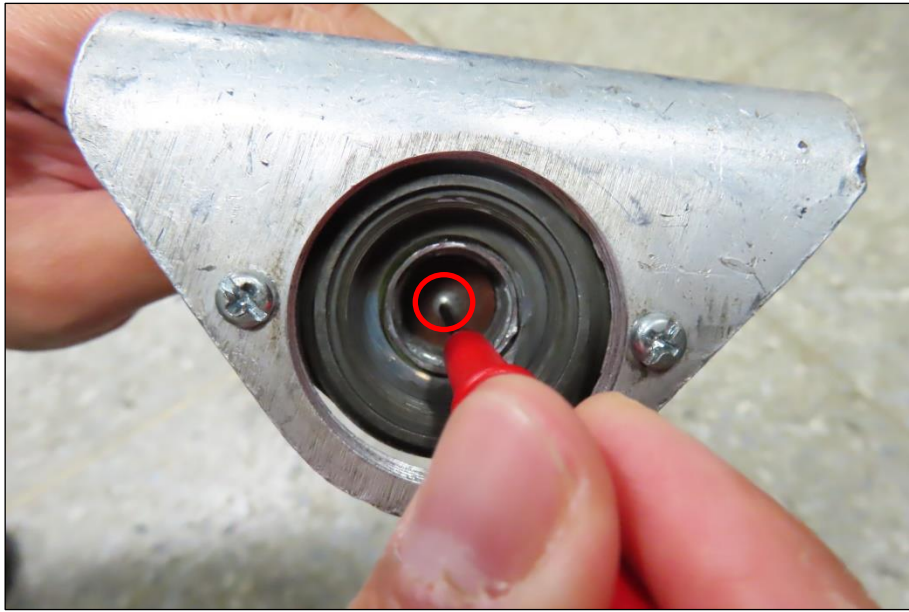
圖 40-紅色探針前端觸碰燈泡座底部金屬正極接點
