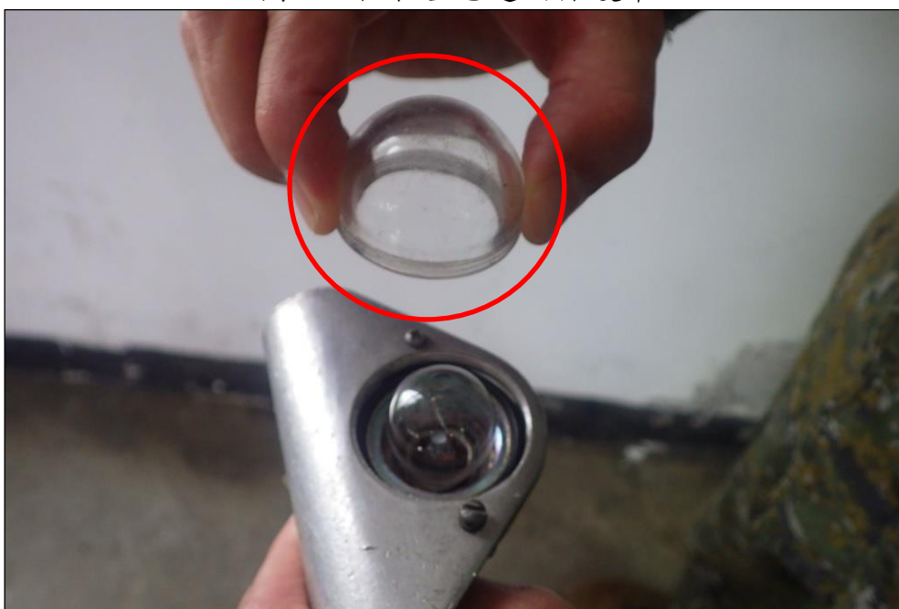
圖 28-取下燈泡透明保護罩
