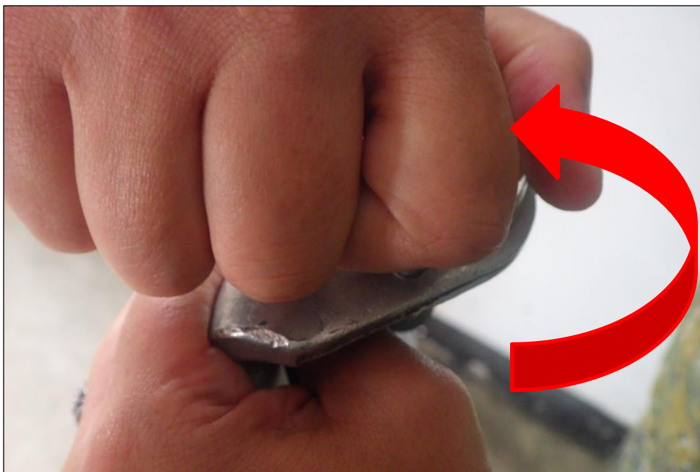
圖 27-逆時針方向旋轉燈泡透明保護罩
