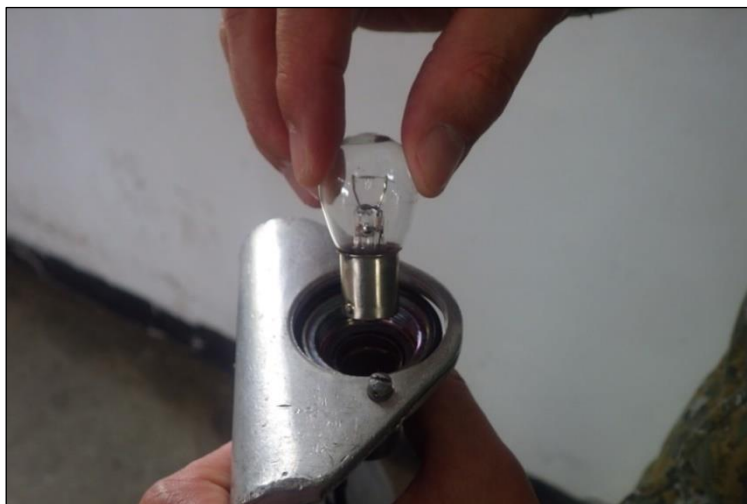
圖 31-迫使燈泡脫離固定槽後取下燈泡
