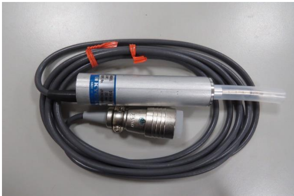
圖 4-7：位移感測器 LVDT
