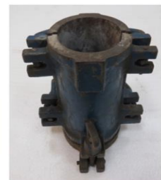
圖 4-1：樑模具 圖 4-2：圓柱模具
