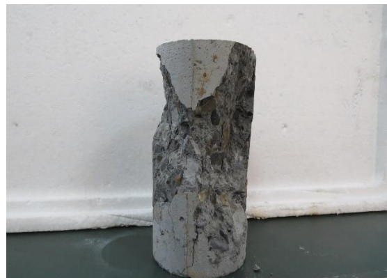
圖8-A 早強混凝土柱
