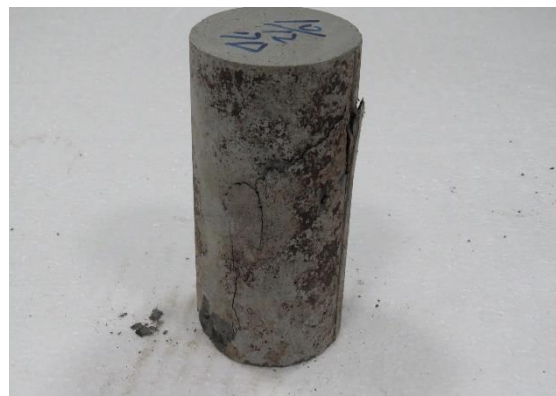
圖8-B 早強鋼纖維混凝土柱
