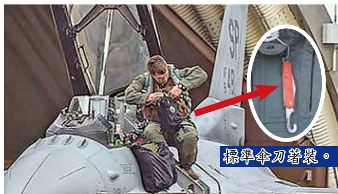
U型刀拉出，置入抗G衣放刀處，並按規定將繩繫妥，避免跳傘後取出使用時滑脫掉落【照片取自美國空軍網站】。
