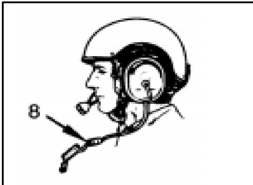
圖 20-戰車乘員通信頭盔快速解脫器位置圖
