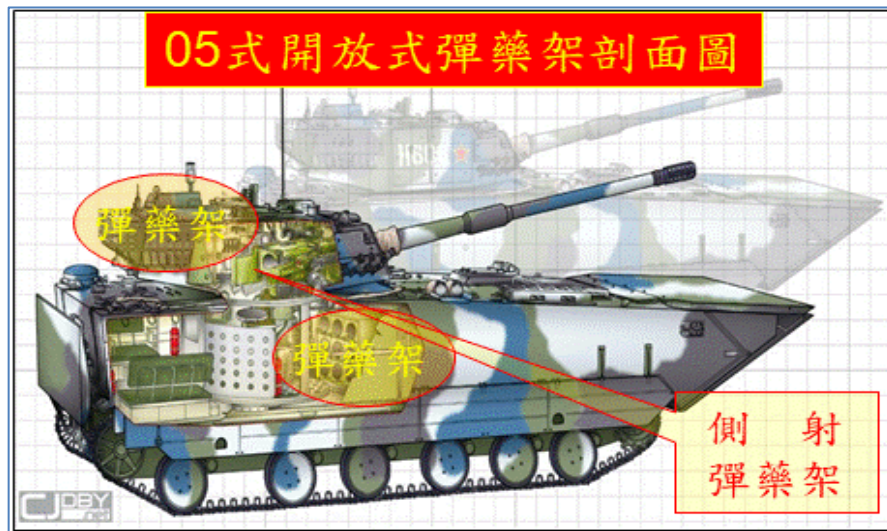
圖6- 05式兩棲突擊砲車彈藥架剖面圖
