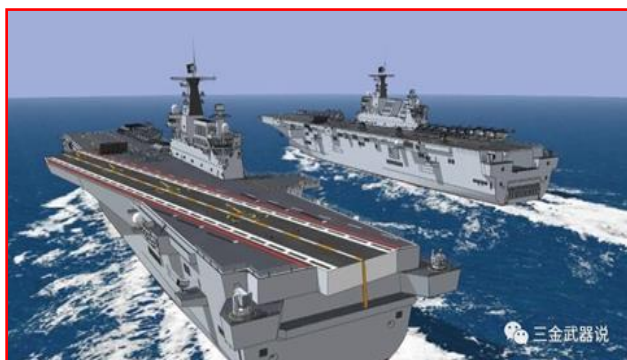
圖10.11-解放軍076型兩棲攻擊艦構型示意圖
