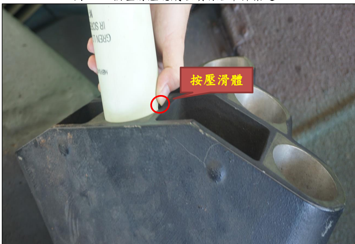
圖 52、按壓滑體總成繼續將煙幕彈藥送入
