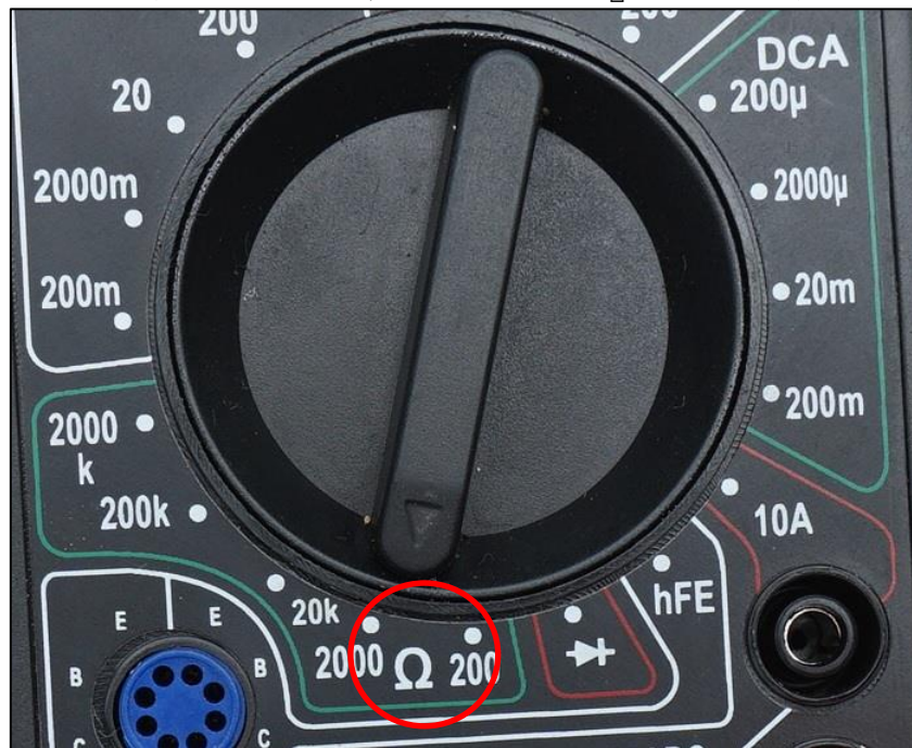
圖 45-三用電表『Ω-歐姆值』電阻量測
