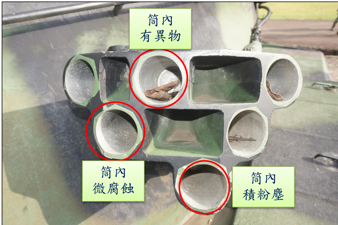
圖 16-投擲筒未覆蓋遭受異物、粉塵滲入產生腐蝕現象
