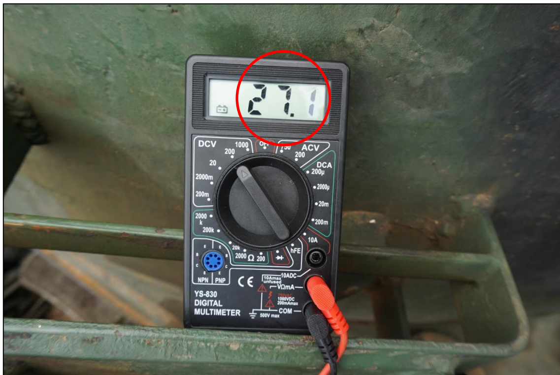
圖 31-顯示電壓值約 22 至 28 伏特之間
