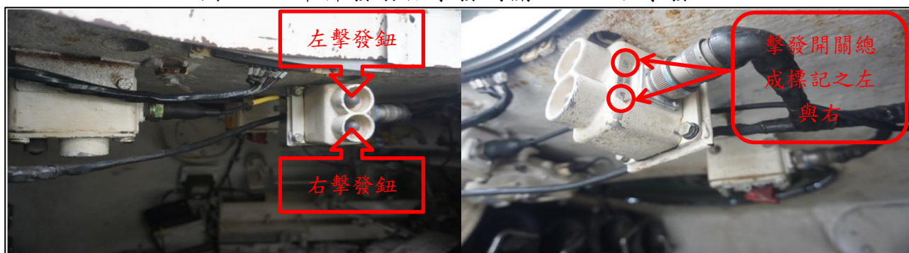
圖 10-煙幕彈發射器擊發開關之左、右擊發鈕
