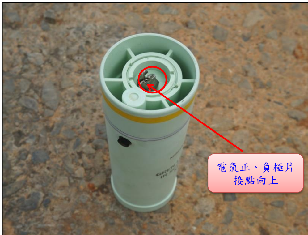
圖 46-電氣正、負極片接點向上
