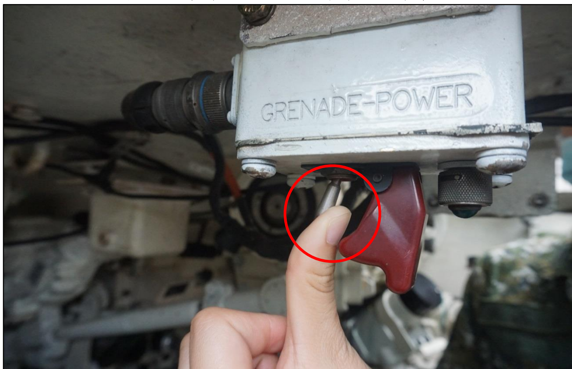
圖 32-煙幕彈發射器電源開關扳至關斷位置
