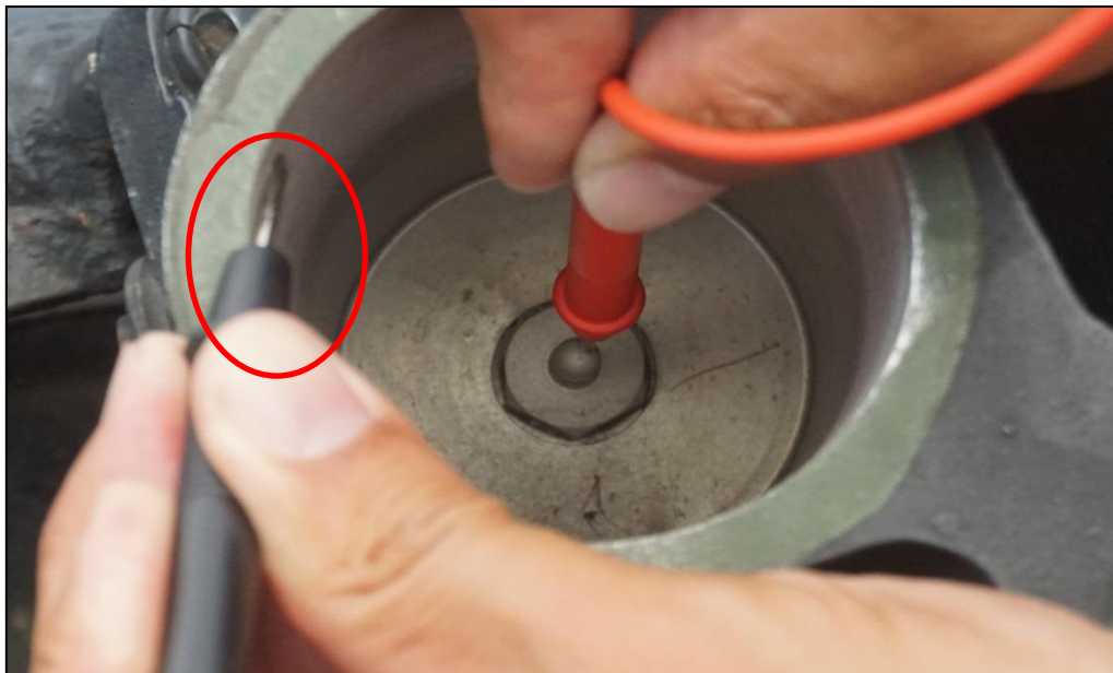
圖 29-黑色探針接觸投擲器內壁形成接地
