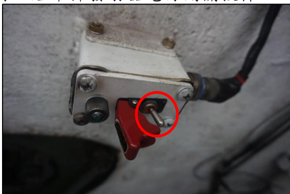
圖 4-煙幕彈發射器電源開關扳桿
