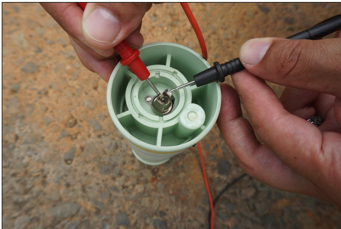
圖 47-紅色探針接觸正極片接點，黑色探針接觸負極片接點
