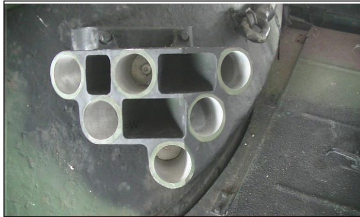
圖 20-發射器總成外觀應完整無缺損
