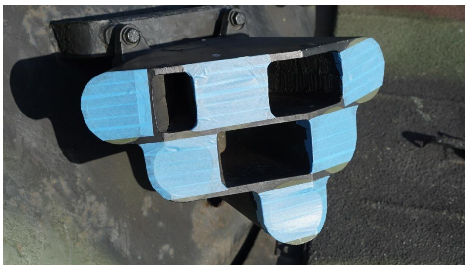
圖 36-以遮蔽膠帶將發射筒及洩水孔完全密封
