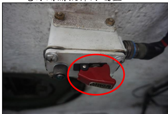
圖 3-煙幕彈發射器電源開關扳桿防護蓋
