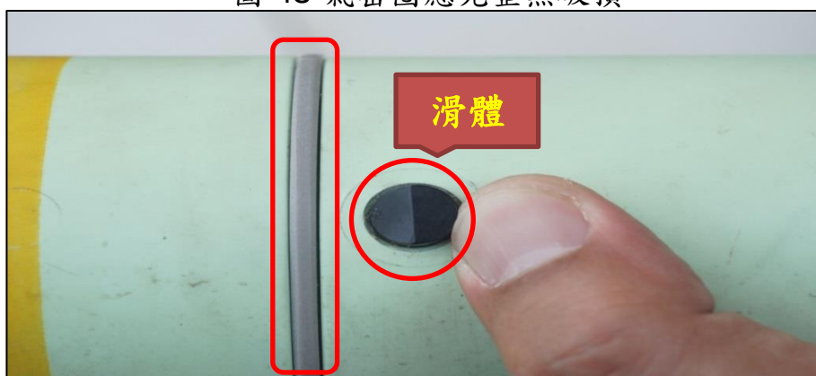
圖 43-氣密圈應完整無破損
