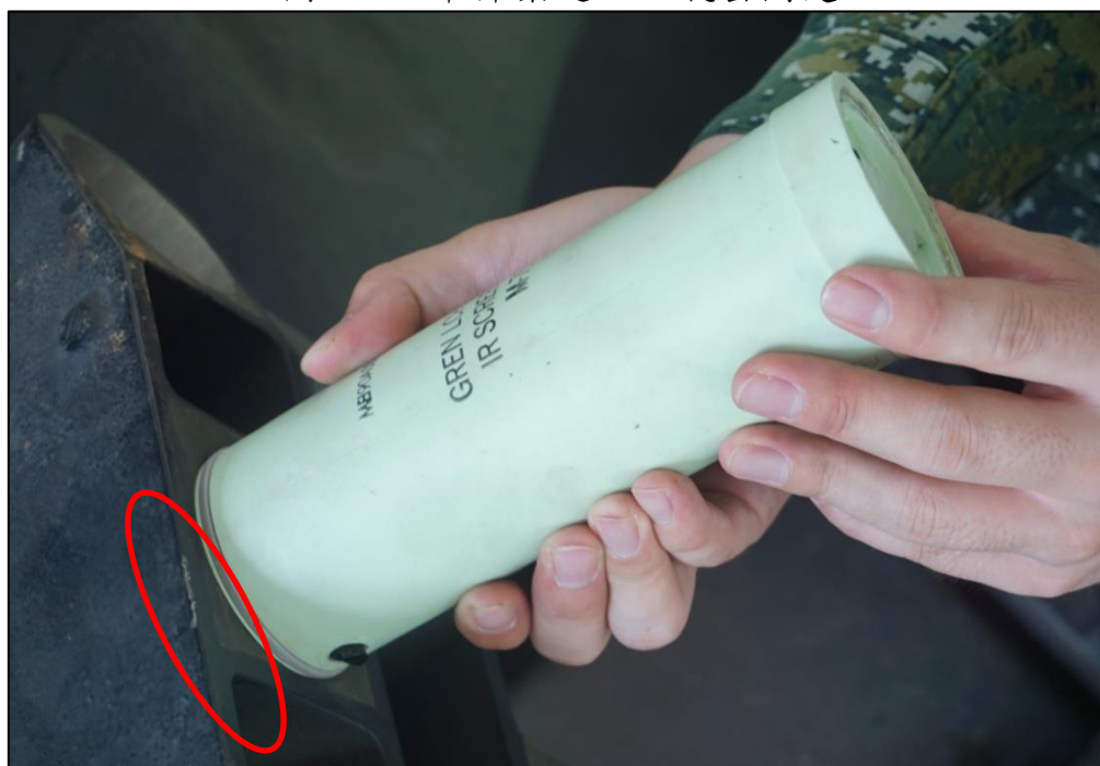
圖 50-煙幕彈藥送入至氣密圈處
