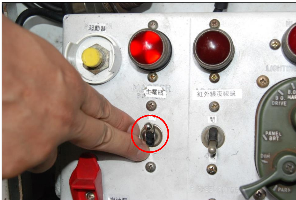
圖 25-底盤主電源開關扳至開啟位置
