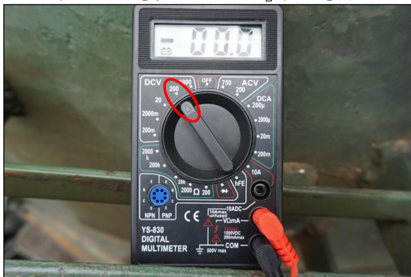
圖 27-三用電表至於『DCV』直流電檔位
