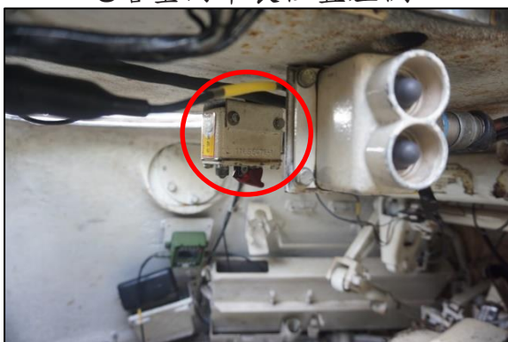
圖 2-煙幕彈發射器電源開關位於砲塔室內車長位置左側
