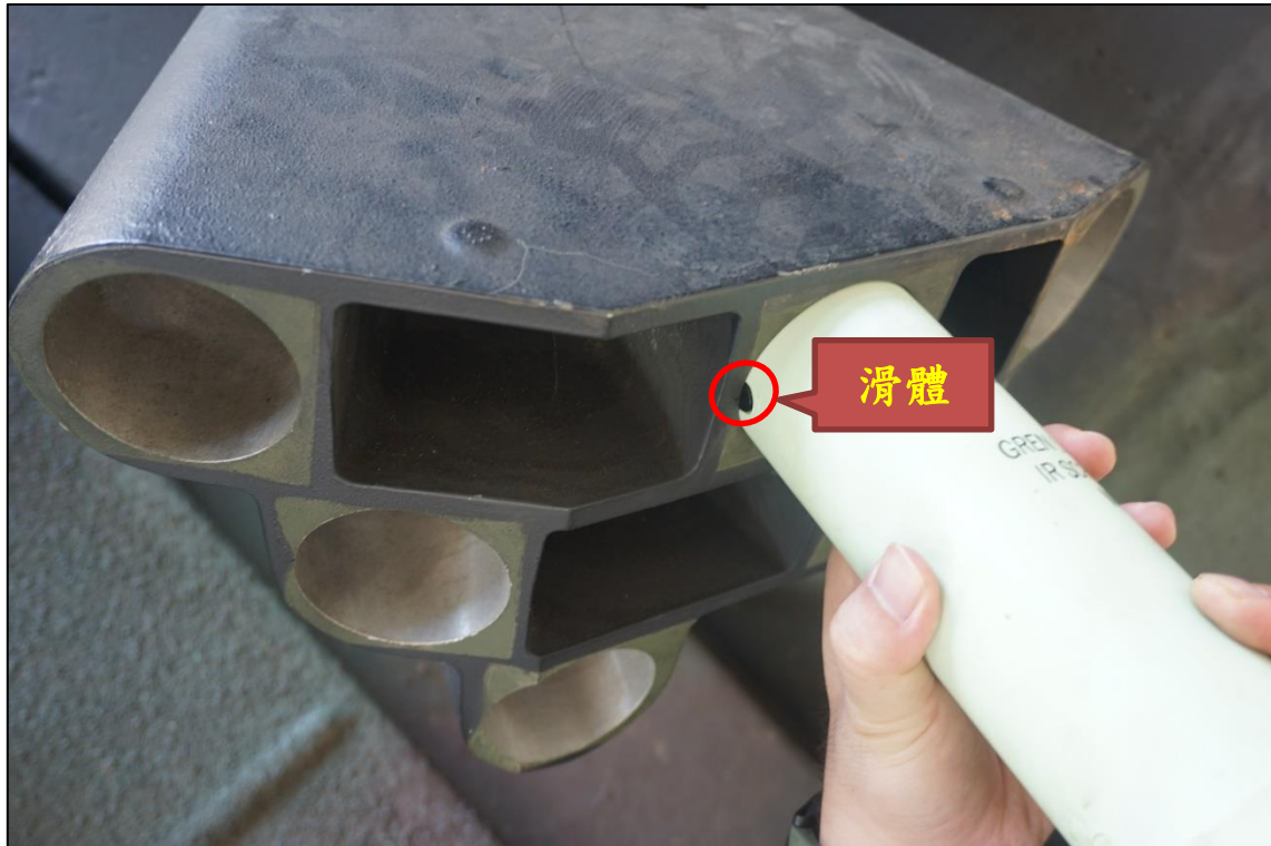
圖 53-滑體總成已進入發射壁不需再按壓滑體
