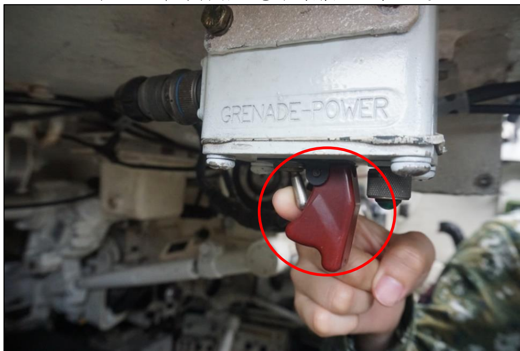
圖 26-煙幕彈發射器電源開關扳至開啟位置
