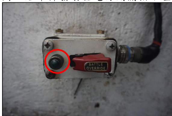
圖 5-煙幕彈發射器電源開關指示燈
