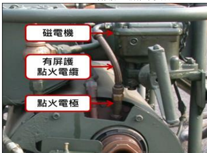
圖 2 啟動組-點火系統
