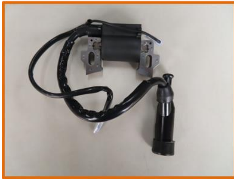
圖10 高壓點火線圈
