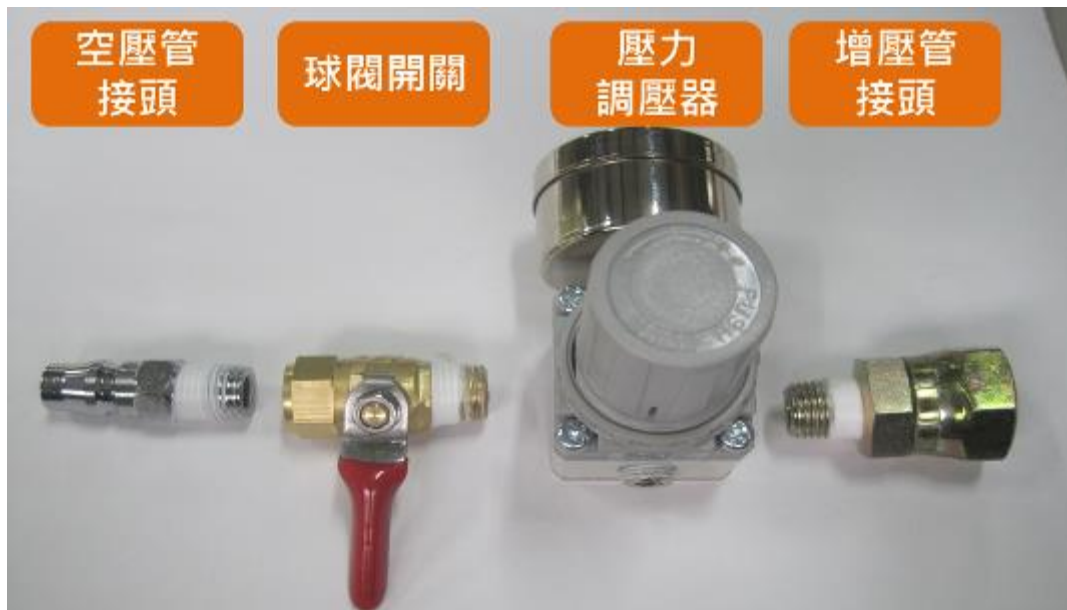
圖 14 泵浦組測試器組件圖
