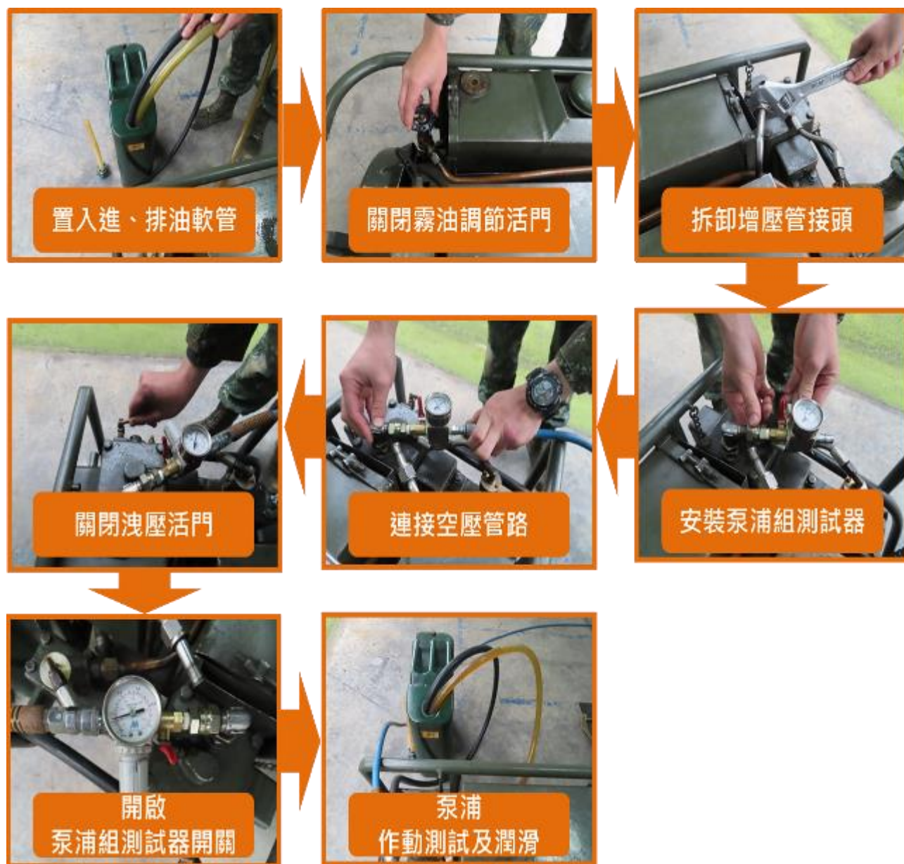
圖 22 泵浦組測試器-測試流程圖
