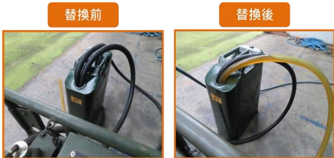
圖 17 替換後進油軟管
