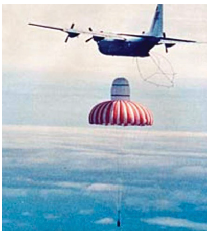
一架JC-130運輸機正在回收Mark8型降落傘拖曳的圓錐艙內偵察衛星拍攝到之底片。在U-2高空偵察機遭擊落後，美國運用衛星影像記錄相關資料。(Source: USAF)
