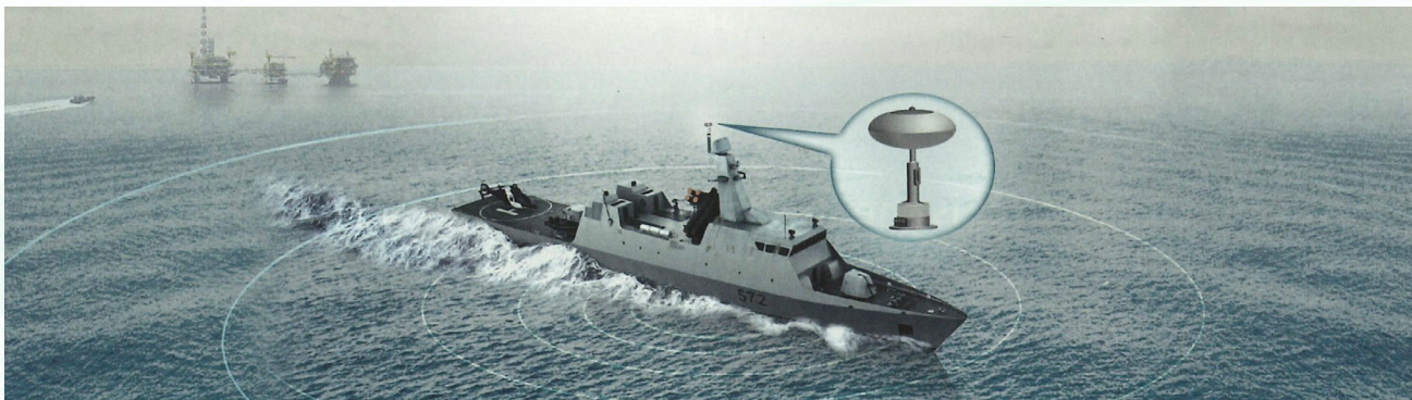
艦載通信情報系統通常可以偵測數十哩範圍內的發射器，在浮升器或繫留無人機安裝通信情報系統等技術，可以大幅延伸偵測距離。(Source: IAI)
