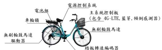
圖10. 新型電力輔助自行車及控制部件
