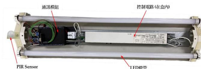
圖 6. 所提出的辦公室照明系統之 LED 燈原型
