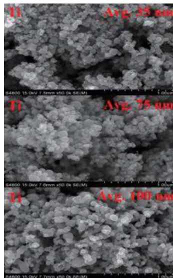
Fig. 4. SEM images of nano-sized Ti powders
