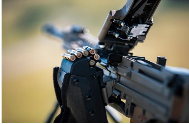
圖三：5.56公厘MG4A3機槍彈鏈示意圖
