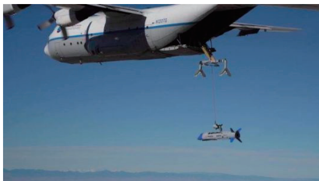
圖5 C-130 運輸機回收 X-61「小精靈」小型無人機
