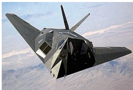
圖3 隱形外型設計以 F-117 型機為例
