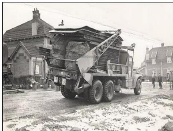
圖12 美軍工兵部隊M2鋼質車轍道橋卡車 資料來源：〈軍武次位面〉， https://read01.com/jNLdLND.htm#image-1 ，檢索日期：西元2022年3月20日。
