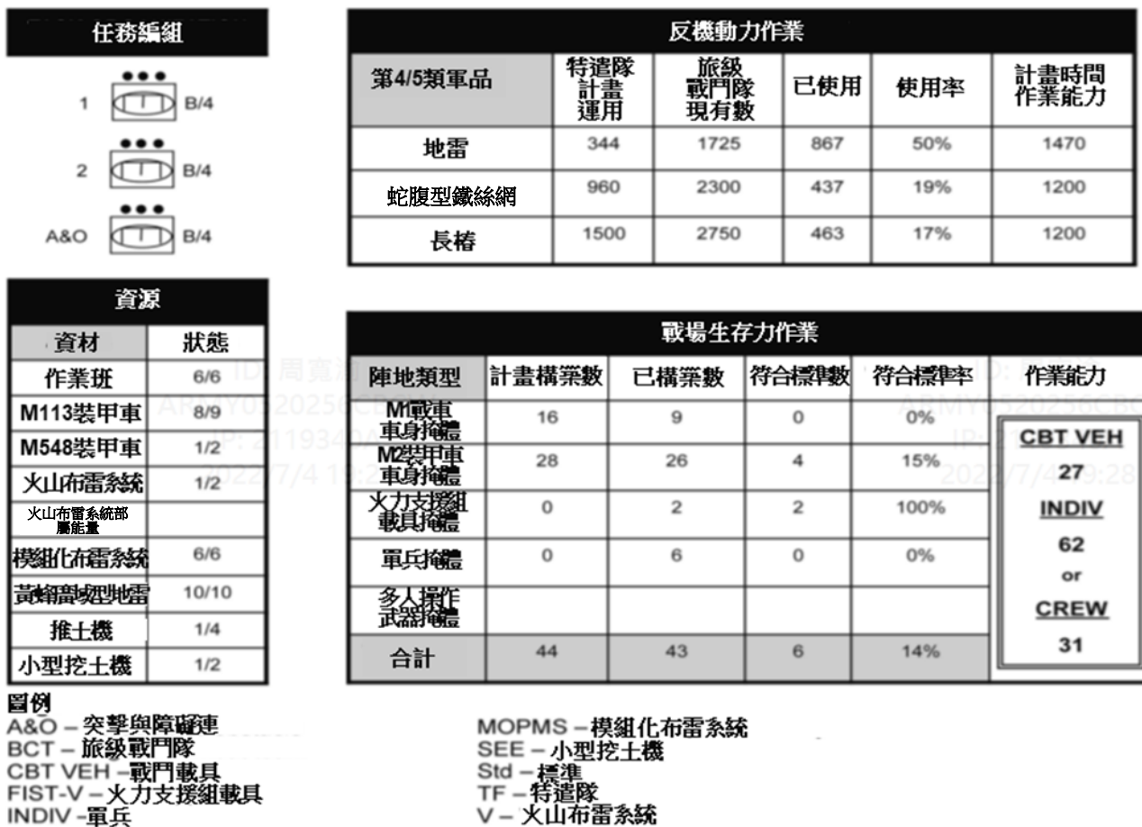
圖 C-4. 指揮官工兵作業參數卡以表格呈現用於掌握反機動及戰場生存力作業量(範例)
