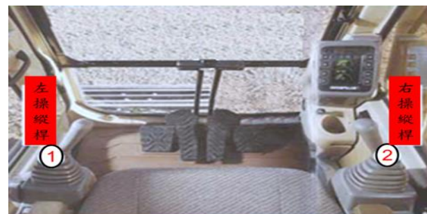
挖土機操作桿
