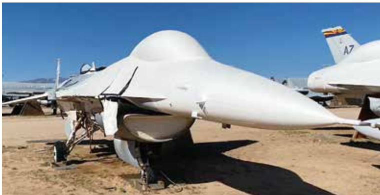
圖為美國F-16型機環控存儲實況（取自美國空軍），法國SMP小組針對我國潮濕環境，將待件M-2000型機使用航太膜封存，避免水氣或鏽蝕影響復飛進度。
