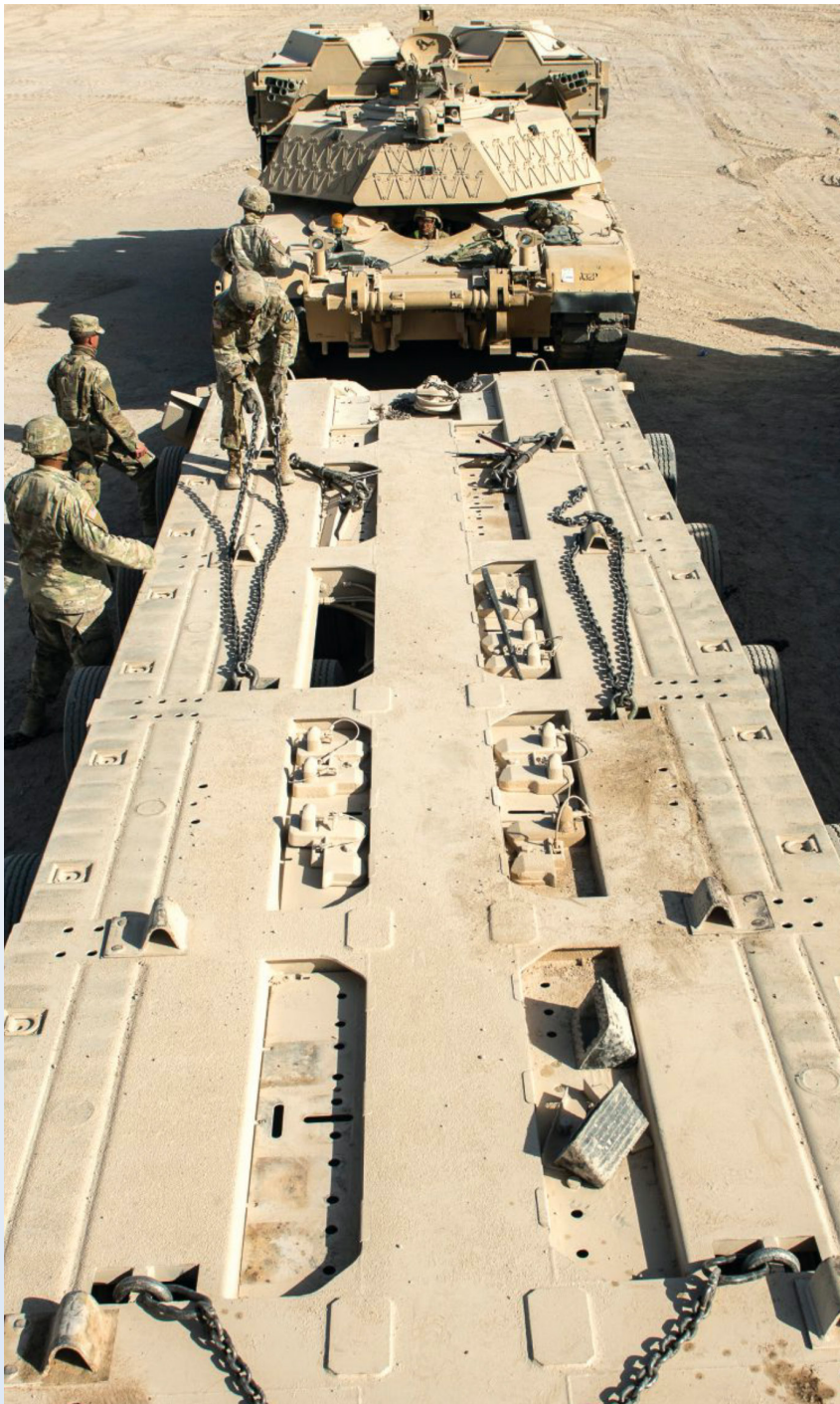
第1916支援營官兵於該訓練中心準備將一輛M1突擊破障車(Assault Breacher)裝載至M1070重裝運輸車上。(Source: US Army/Matthew Johnson)
