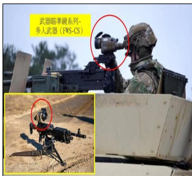
圖26-FWS-CS機槍瞄準鏡系統
