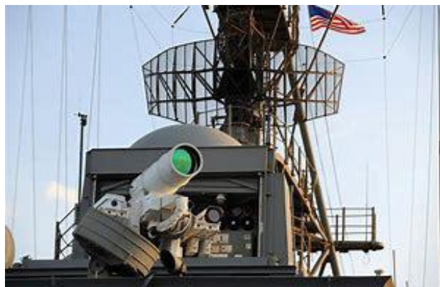
圖1 在USS Ponce驅逐艦上的30kw級雷射武器系統. Foto US
