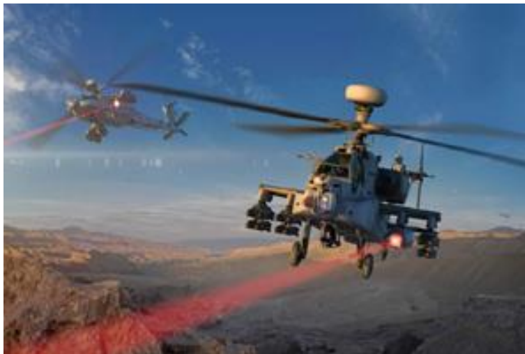
圖 6 AH-64 阿帕契直升機裝載高能雷射武器（HEL） 新墨西哥 2017
