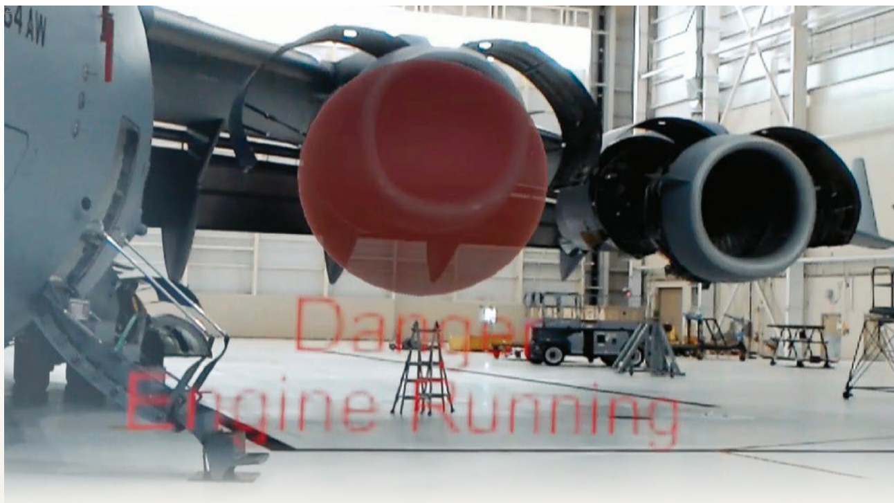
透過擴增實境眼鏡，使用者可以在實物前方看到危險警告訊息，使其在面對危險情況(如運轉中的發動機)時提高警覺。MOTAR企圖研發標準介面，讓虛擬實境科技得以搭載商用軟、硬體。(Source: USAF/Timothy Kirchner)
