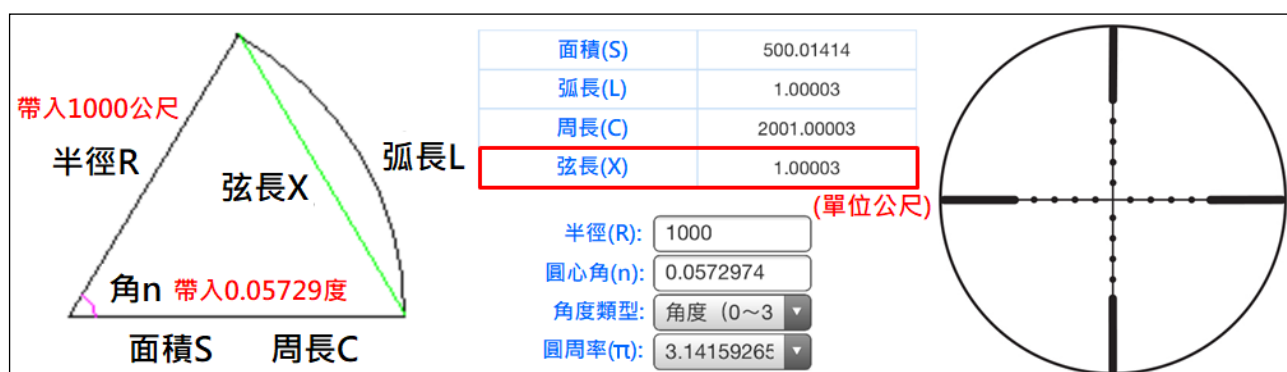
圖三 以數學解釋 100 公尺 1 米位之夾角大小及米位刻劃鏡示意圖
